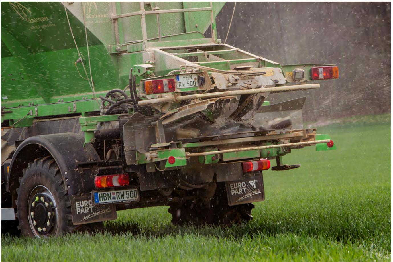
Auf die Breite kommt es an: 18 Meter Arbeitsbreite bietet der Güstrow-Aufbaustreuer auf dem Unimog.
